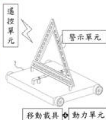
圖2. 遙控移動式警示裝置結構圖
