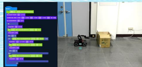
圖5. 車體感測障礙物並停止爾後判斷決定轉身或繞開
